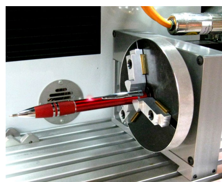
Dispositivo rotante per la marcatura di pezzi cilindrici
